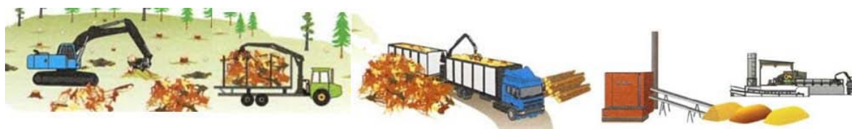
Figur 1. En typisk produktionskedja för stubbar
